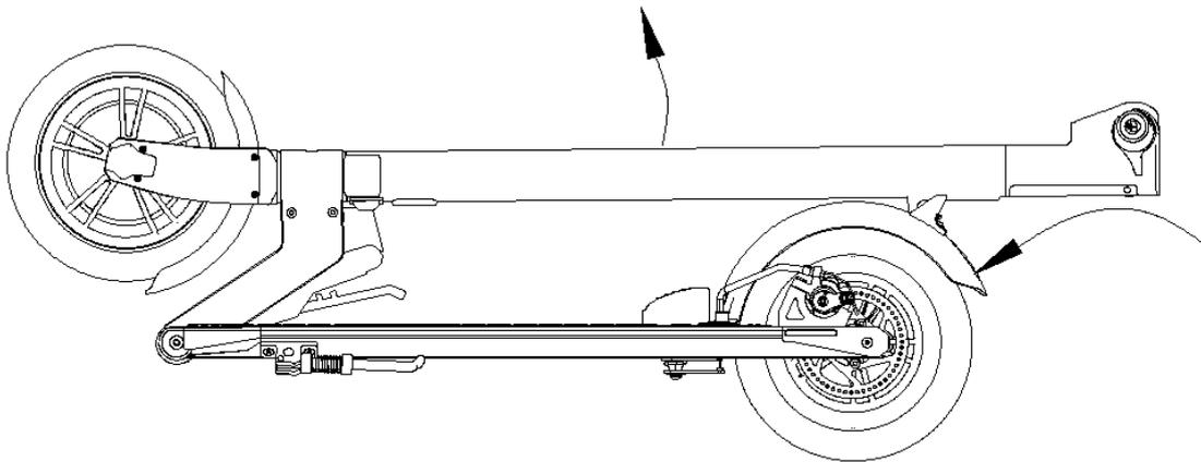
**Enlever la protection en plastique, et dévissez les 2 vis du crochet avec l'outil fourni.**
