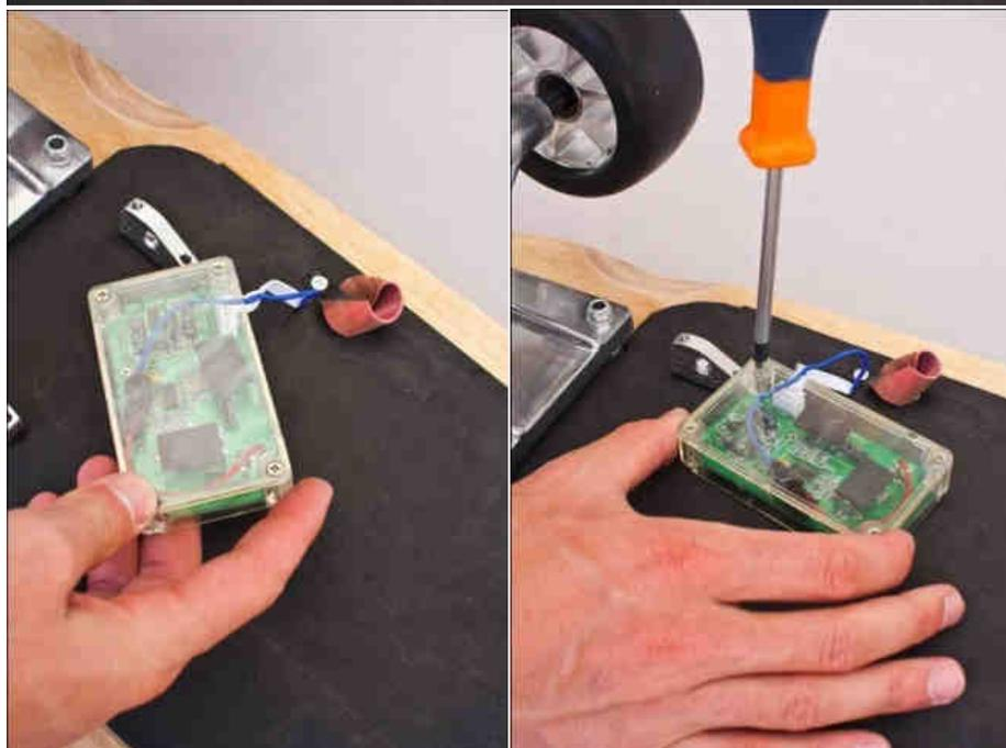
Une fois le capot ouvert, déconnecter les fiches, remplacez votre boîtier et reconnectez-le. Repositionnez le capot du boîtier, visser le et replacer le boîtier comme à l'origine dans son élastique
