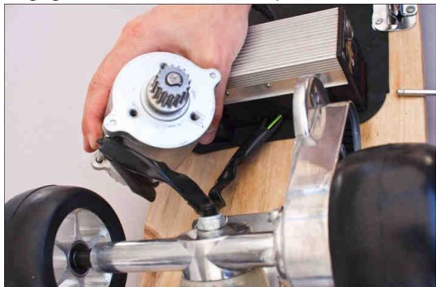
Connectez le nouveau moteur au boîtier de contrôle et repositionnez le bien dans son emplacement, face au trou et visser les boulons un à un progressivement.
