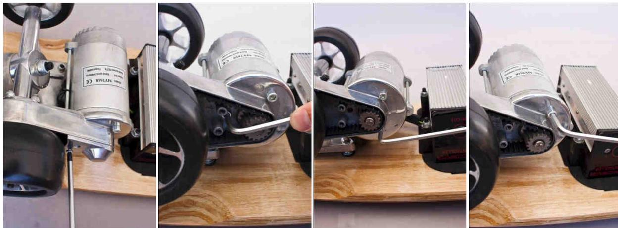
Dégagez le moteur de son emplacement et déconnecter le du boîtier de contrôle.
